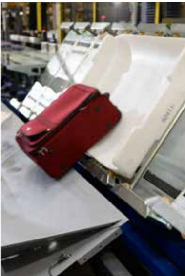
Lastangaben für die horizontale Fördertechnik werden für den ungünstigsten Fall durchdacht und das ist das Anfahren mit Volllast z. B. nach einer Blockade oder einem Stau. Hier werden oft Sicherheitspuffer von  $\geq 20\%$  berechnet. Bei der Konstruktionsauslegung werden meist weitere  $\geq 20\%$  als Sicherheitspuffer bedacht, die in der Gesamt-
