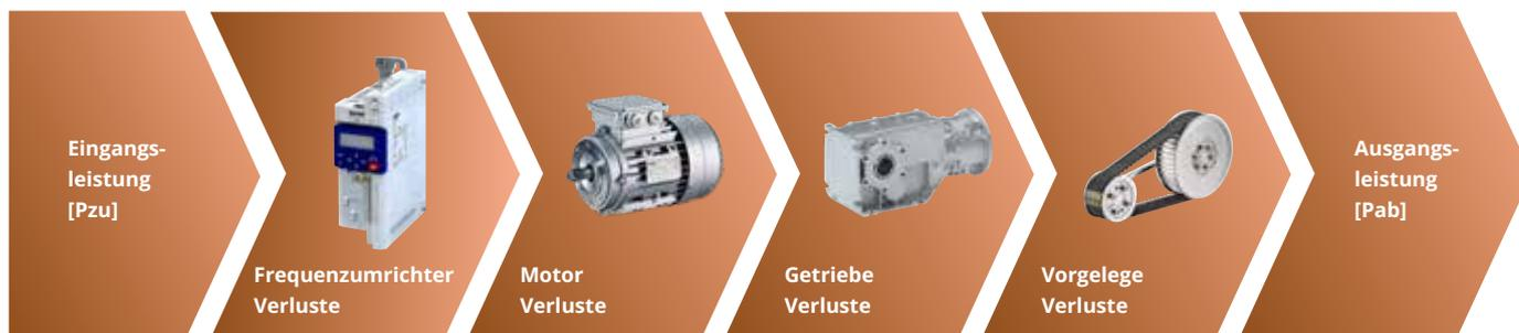
$$\eta_{\text{Gesamt}} = \frac{P_{\text{ab}}}{P_{\text{zu}}} = \eta_{\text{Frequenzumrichter}} * \eta_{\text{Motor}} * \eta_{\text{Getriebe}} * \eta_{\text{Vorgelege}}$$
